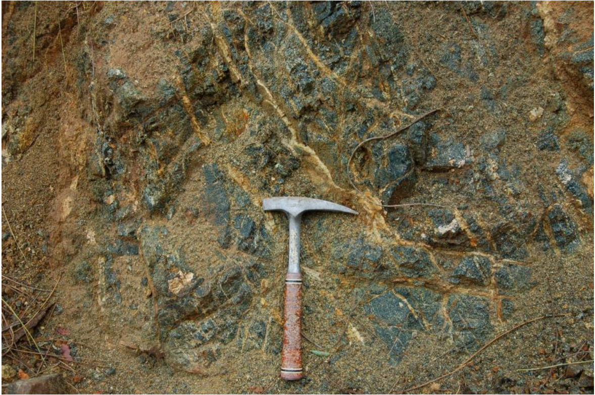
Foto 55. Intenso “veining” en gabros sericitizados, con mineralización diseminada de hematites especular y calcopirita ( \pm Au).
