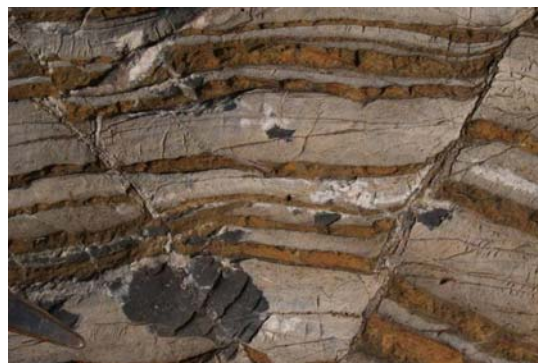
Foto 37. Fallas extensionales conjugadas de orientación NO-SE (dexas) y NE-SO (senestras) en las Calizas del Cámbrico inferior de Cazalla de La Sierra.
