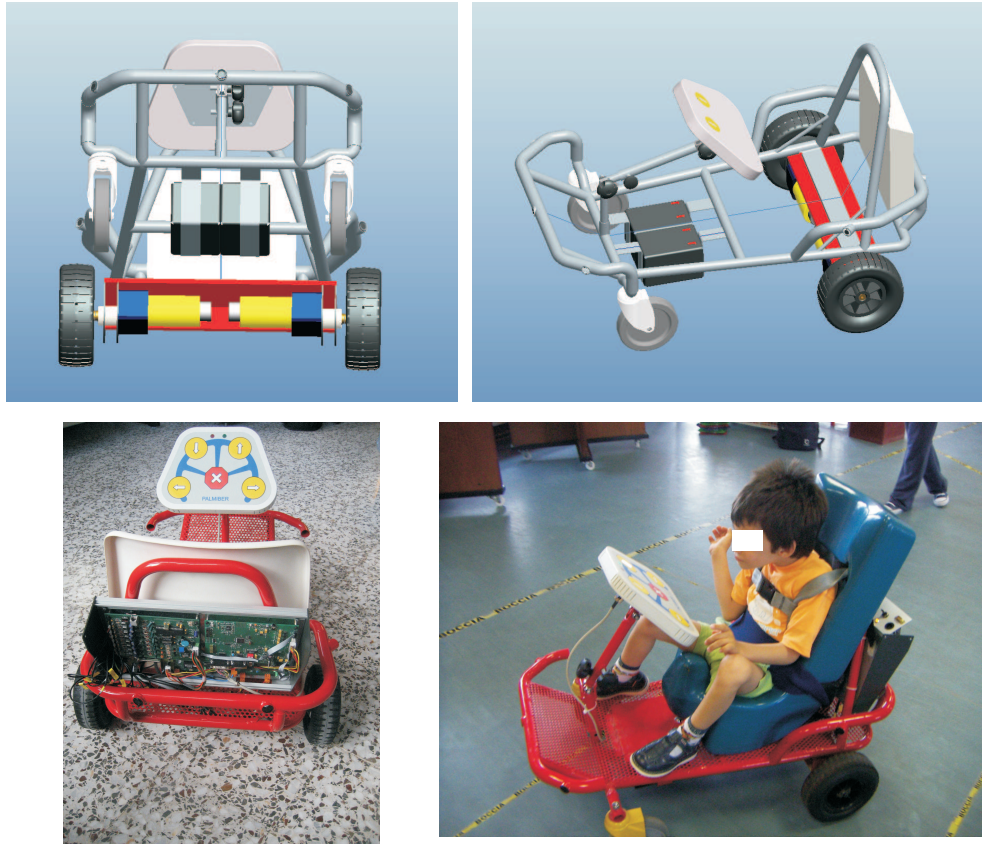
Figura A.3: Diseño CAD y fotografía del primer prototipo del vehículo PALMIBER desarrollado en colaboración con el consorcio del proyecto PALMIBER
