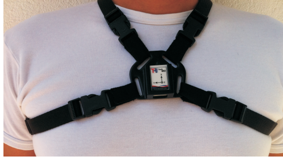
Figura 5.17: Sensor inercial situado en el tronco del usuario para establecer el sistema de referencia global necesario para la medida de orientación relativa entre el movimiento de la cabeza del usuario y del vehículo
