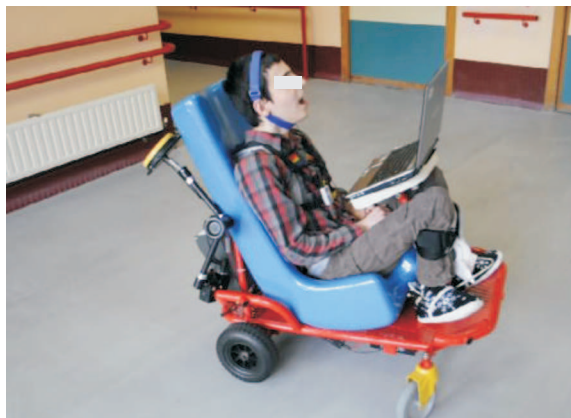
Figura 5.19: Fotografía tomada durante la experimentación de la interfaz inercial como dispositivo para la conducción del vehículo PALMIBER en ASPACE Cantabria
