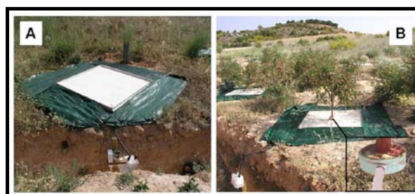
Figura 5.5 "Caja de interceptación testigo" (A) y "caja de interceptación" con C. arborescens (B). En la Figura 5.5B se observa un detalle del colector de escorrentía cortical.
