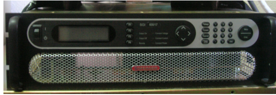
Fig. A.13. Fuente de alimentación SGI 600/17 de Sorensen.+
