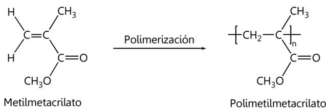
**Figura 3. 1:** Polimerización de metilmetacrilato (MMA).
