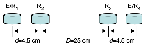
Figura 2.5. Estructura sensorial propuesta por [Ureña, 1998] para discriminar entre planos/esquinas y salientes.
