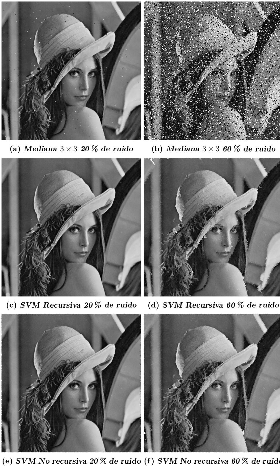
Figura 5.26: Aplicación de la técnica de mediana modificada usando SVM (SVM-Mediana-1). Se incluye en (a) y (b) los resultados para la mediana clásica.
