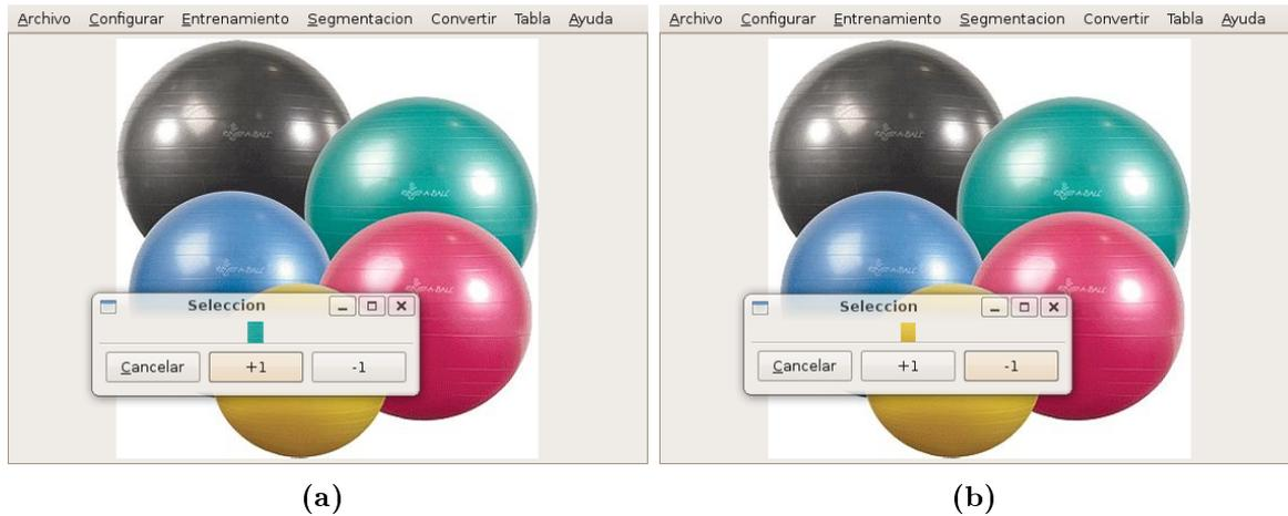
Figura 4.15: Ejemplo de extracción de colores en una imagen. (a) Extracción del color a detectar (b) Extracción de colores a descartar.
