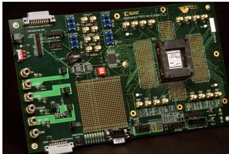
**Figura 6.3.** Vista general de la tarjeta de evaluación HW-AFX-FF672-300 empleada en esta tesis.
