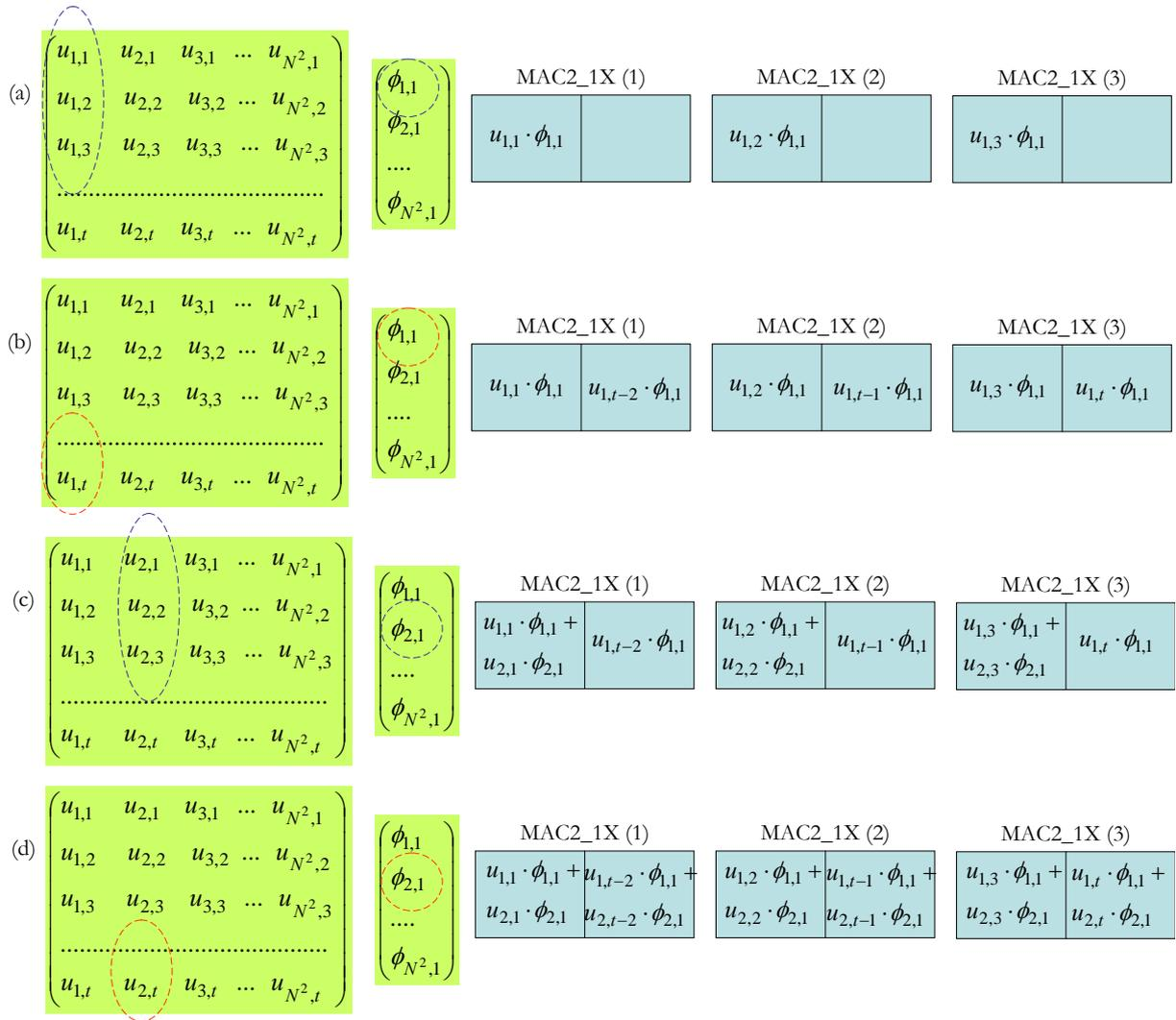
**Figura 4.86.** Secuencia de datos de  $\mathbf{U}_t^T$  y  $\Phi_j$  y contenido de las celdas MAC2 del array semi-stoquístico: (a) Generación de los primeros datos para los 3 primeros autovectores, (b) Generación de los primeros datos para los 3 segundos autovectores, (c) Generación de los segundos datos para los 3 primeros autovectores (d), Generación de los segundos datos para los 3 segundos autovectores.
