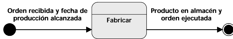
Figura 3.51 Ejemplo de representación de procesos mediante diagramas de estado de UML
