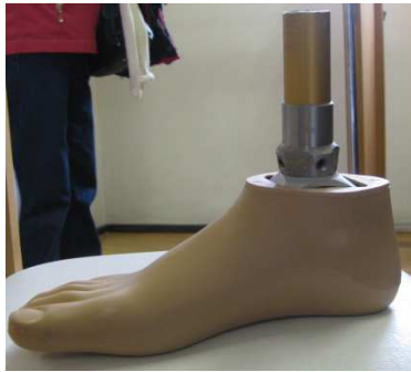
Figura 3.5: pie de carbono del paciente en la prueba de la prótesis.
