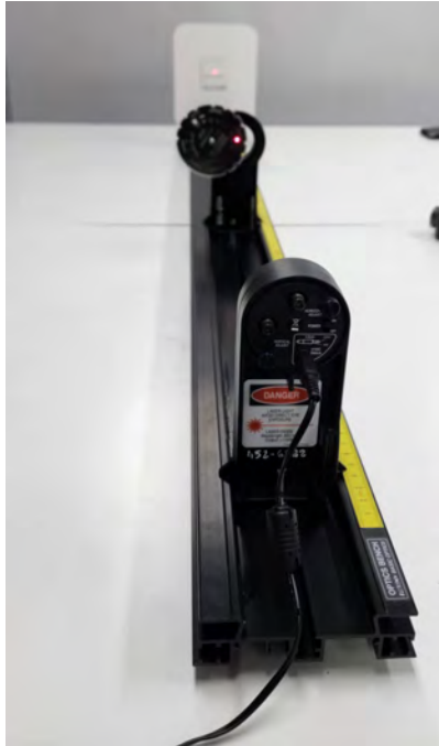
Fig. 1. Montaje del banco óptico de interferencia y difracción de la luz, constituido por: un riel óptico, un soporte porta rendija, una pantalla blanca y un láser monocromático.
