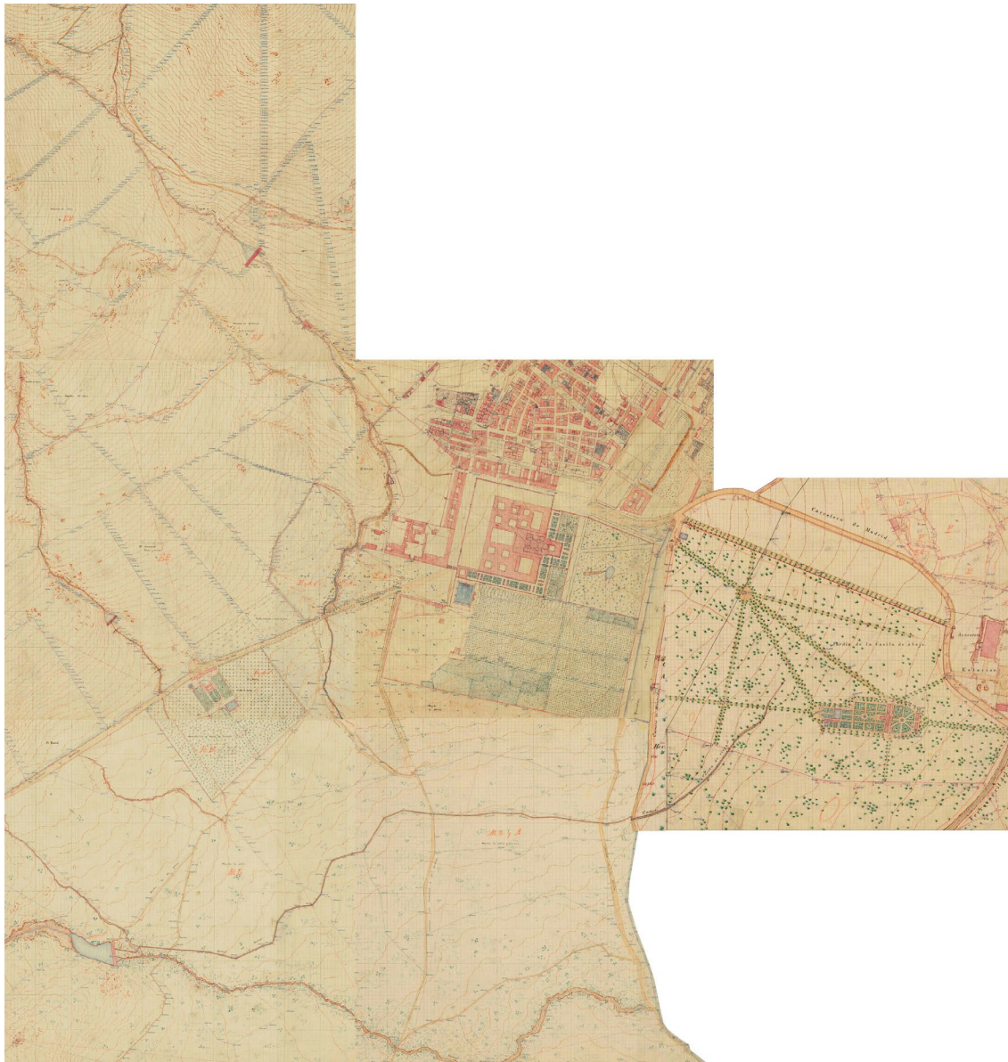
Figura 15. Cartografía Catastral de España, 1860-1870: términos de San Lorenzo y de El Escorial. Escala original 1:2.000, curvas de nivel cada 5 m. Composición de las Hojas Kilométricas del Catastro de rústica que muestra el conjunto de la red de abastecimiento al Monasterio y a los dos Casinos. Montaje de los autores. Originales: Instituto Geográfico Nacional.
