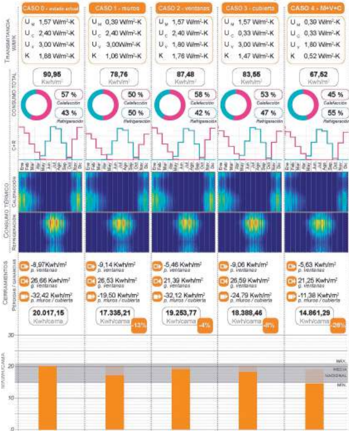
Figura 5. Datos comparativos de demanda energética del H. Ramón y Cajal de Madrid para climatización según casos de estudio (Fuente: elaboración propia).
