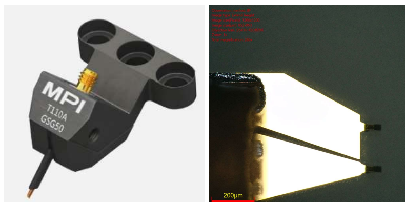
Figura 4.15: Sonda de medida RF [118] e imagen tomada por el microscopio de las micropuntas de la sonda.
