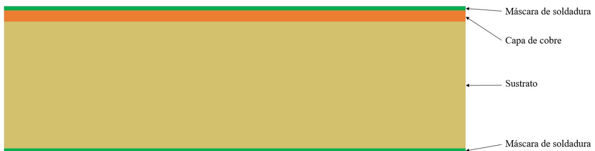
Figura 2.18: Estructura de una PCB de una cara.
