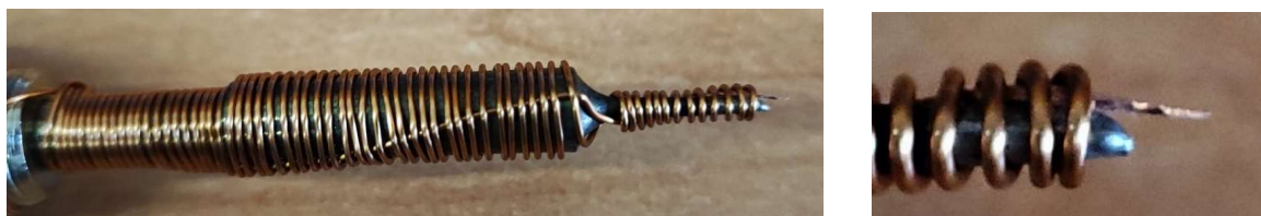
Figura 7.10: Soldador con cable de cobre y punta pulida.
