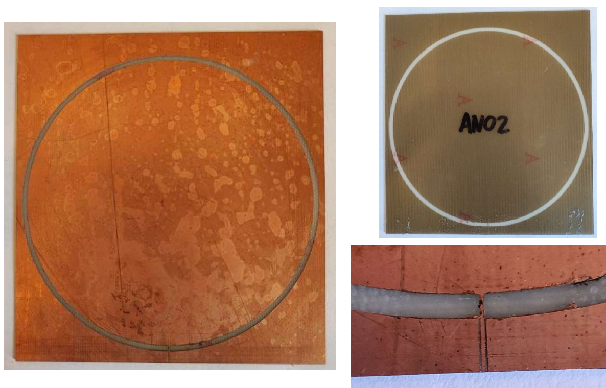
Figura 4.52: Segundo prototipo fabricado de la antena de parche circular con frecuencia de resonancia en 1.1 GHz.
