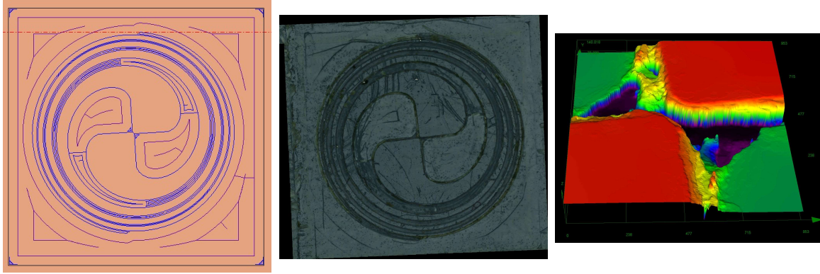
Figura 4.4: Pruebas de fabricación mediante microfresado de la antena de espiral de Arquímedes de 12 mm de lado.
