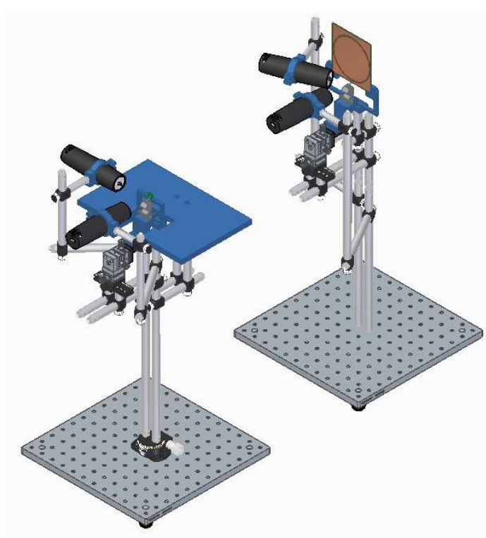
Figura 4.54: Vista isométrica del modelo CAD del primer sistema para los ensayos de ganancia.
