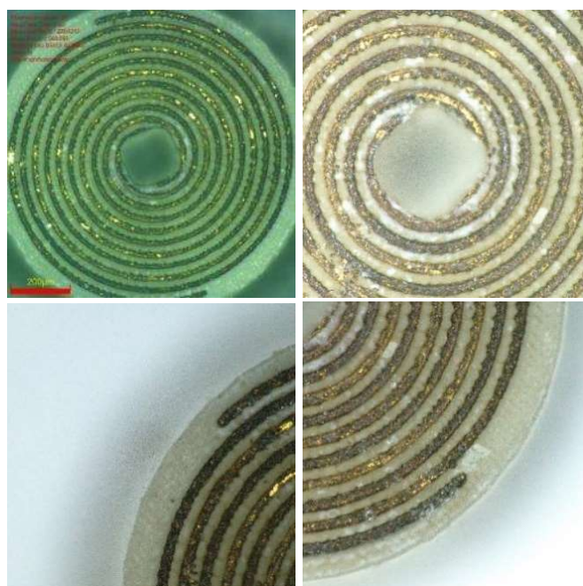
Figura 4.14: Imágenes de los prototipos de la antena de espiral de Arquímedes tomadas con un microscopio digital y detalle de las zonas de interés.
