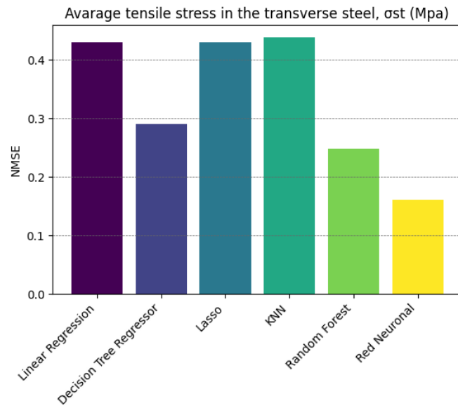
Figura 4.19: Resultados del error NMSE en la variable Average tensile stress in the transverse steel - Multisalida
