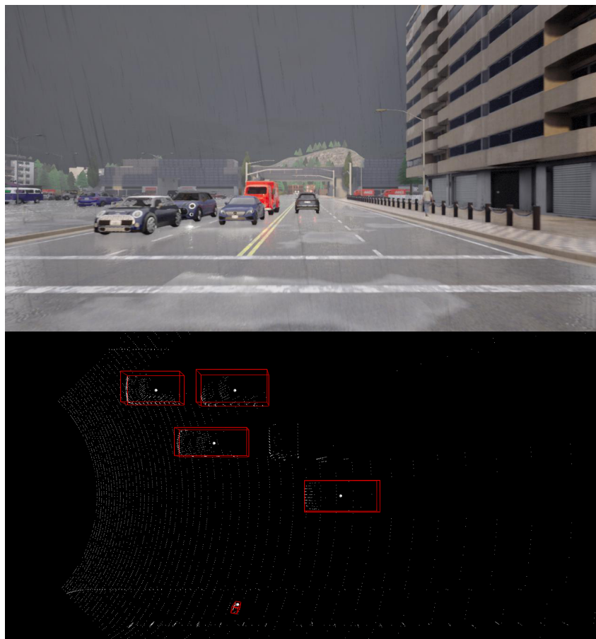
Figura 3.13: Ejemplo de datos proporcionados por SHIFT: a) Imagen RGB b) Nube de puntos de LiDAR y etiquetas.
