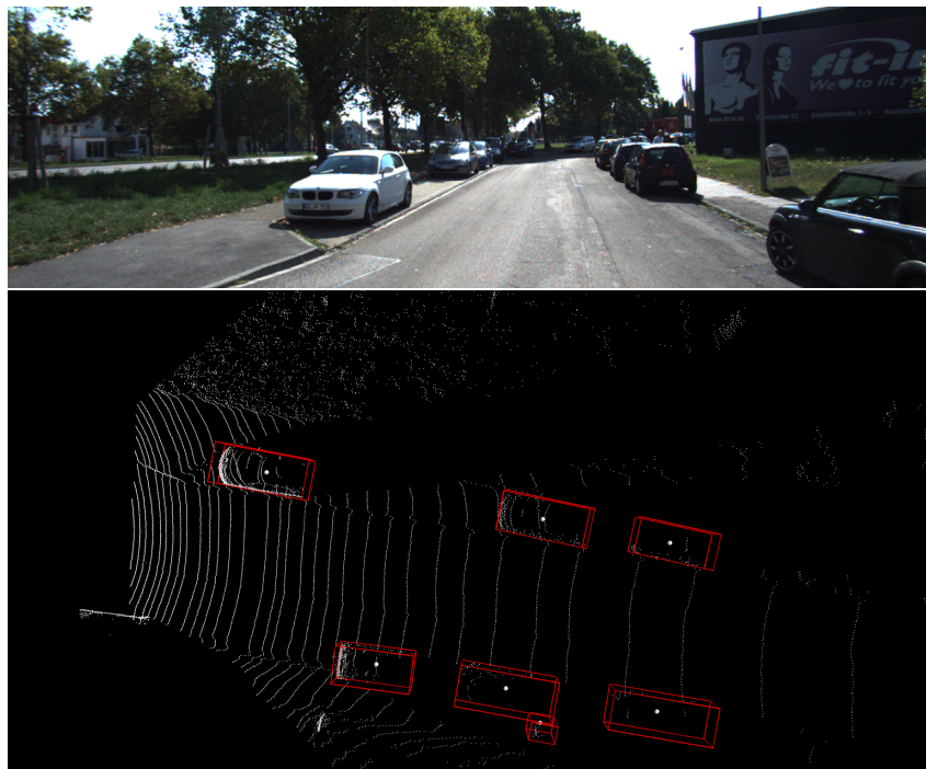
Figura 3.7: Ejemplo de datos proporcionados por KITTI: a) Imagen RGB b) Nube de puntos de LiDAR y etiquetas.
