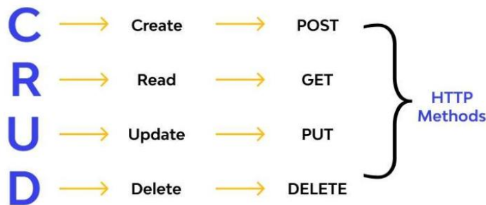
Figura 23: Imagen sobre Operaciones CRUD.
