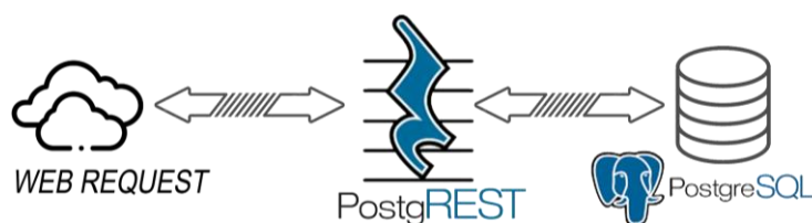
Ilustración 2. diagrama funcionamiento de PostgREST
