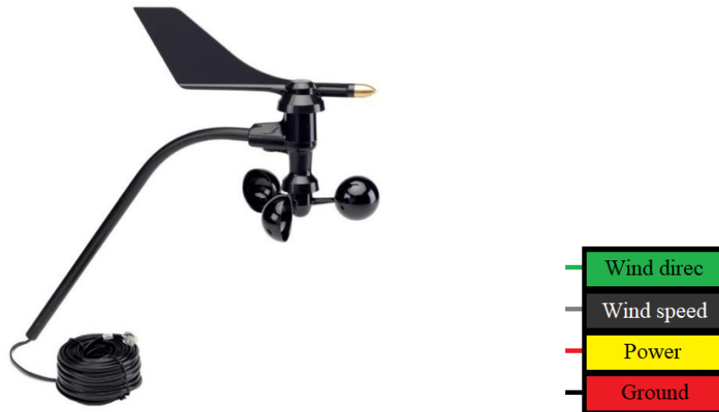
Figura 22. Anemómetro y veleta 6410 de Davis Instrument (izquierda) y sus conexiones (derecha)
