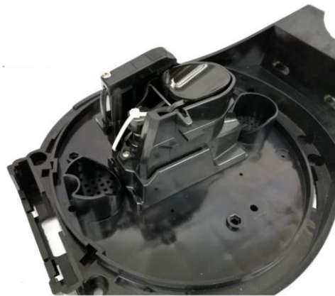
Figura 26. Balancín y sistema de vaciado automático del pluviómetro 6466M de Davis Instrument
