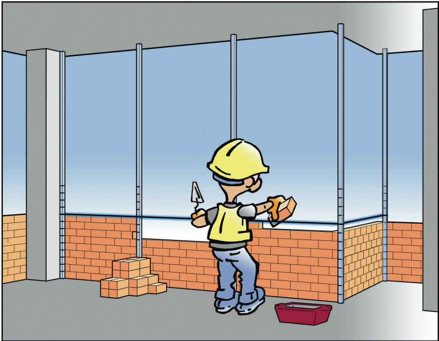
-Dibujo 5- Colocación de miras en cada punto singular de la fachada (huecos, rincones y esquinas). Las miras deben ir escantilladas marcando el alto de las hiladas, dinteles y vierteaguas.
