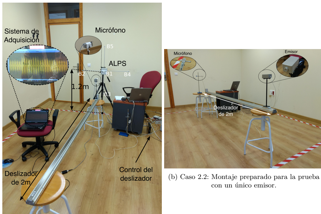
(a) Caso 2.1: Montaje preparado para la prueba con el ALPS.
