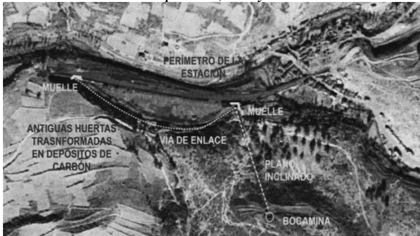
Figura 3. Esquema del conjunto de la estación de Torre del Bierzo en 1946, y su conexión con el plano inclinado y la vía de enlace de Minas de Antracita de Torre, Campomanes, Solís y Cía
