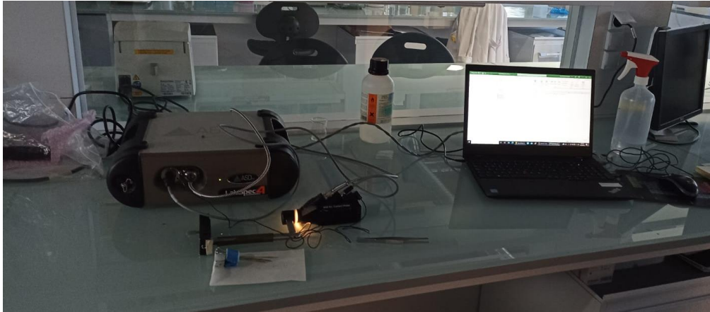
Figura 2. Espectrofotómetro utilizado para tomar los espectros de absorción lumínica de las muestras recogidas. Se trata de un modelo de Analizador de laboratorio ASD LabSpec 4 Standard - Res i de Malvern Panalytical.
