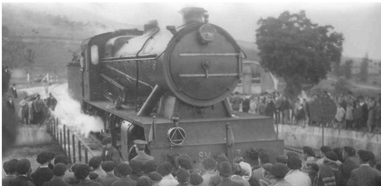
Locomotora del tren inaugural siendo girada en el puente giratorio estación de Horna-Villarcayo, 1929
