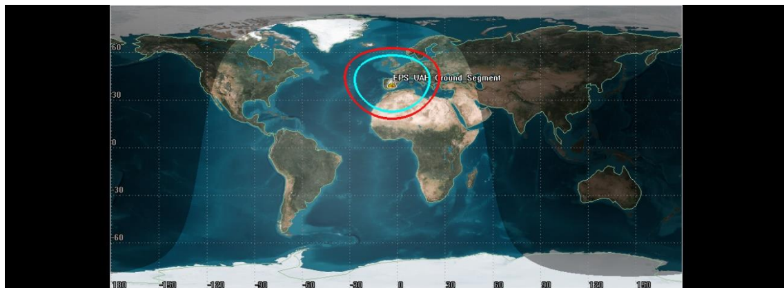
Proyección en 2D de la cobertura a 0^\circ de inclinación (rojo) y a 5^\circ de inclinación (azul) del segmento terreno para un satélite a una altitud aproximada de 514Km de altura.
