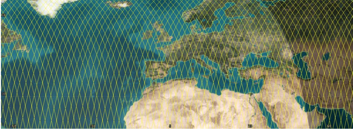
Simulación de la proyección de la órbita del satélite durante un ciclo completo (11 días) sobre un mapa 2D centrado en España, lugar en que se ubicará el segmento terreno.
