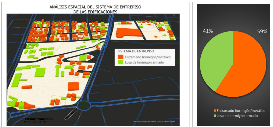
Figura 6.16.- Análisis espacial y porcentual del tipo de sistema entrepiso de las edificaciones
