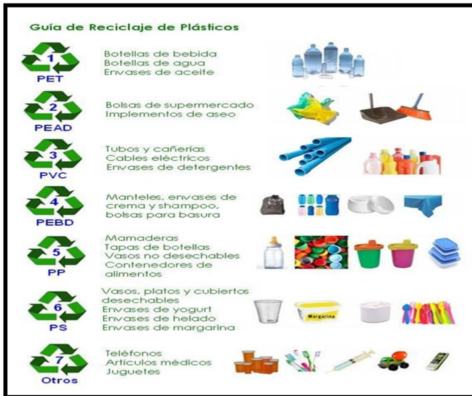
Figura 1.- Tipos de Plástico: Polietileno (PE), polipropileno (PP), policloruro de vinilo (PVC), poliestireno (PS), poliuretano (PU) y tereftalato de polietileno (PET). (Pascual, 2015).
