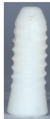
Fig. 52: Implante óxido de Zr.
