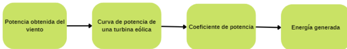
Figura 3.7. Modelado del aprovechamiento energético de una turbina
