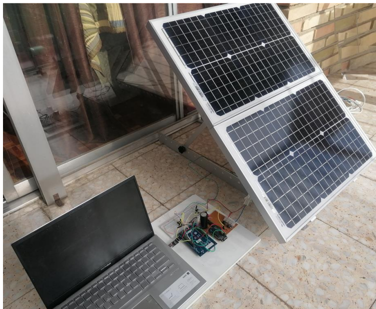
Figura 3.41. Montaje - prototipo del sistema de caracterización.
