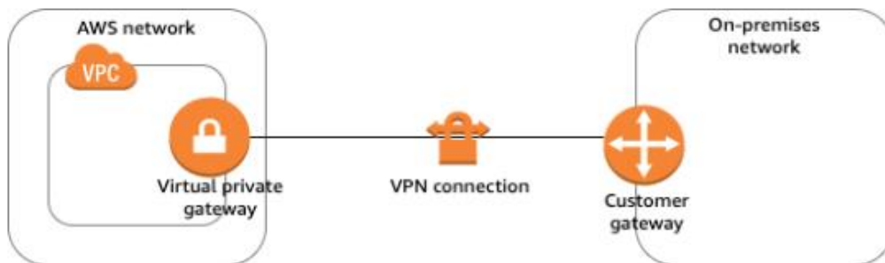
Ilustración 165 Esquema conexión VPN Site-to-Site AWS [38]
