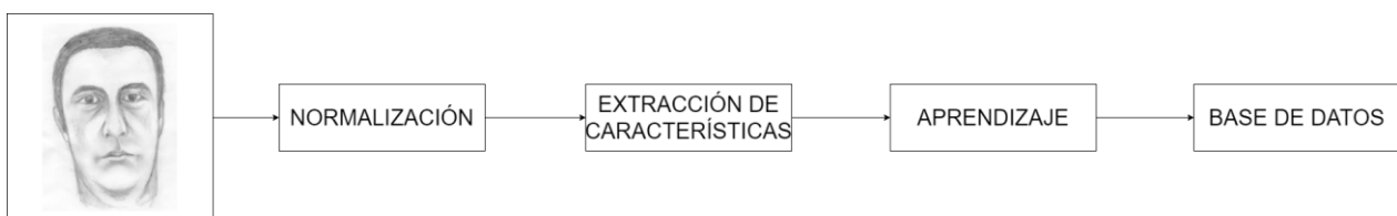
Fig. 2. Diagrama del proceso de identificación a través del modo aprendizaje.
