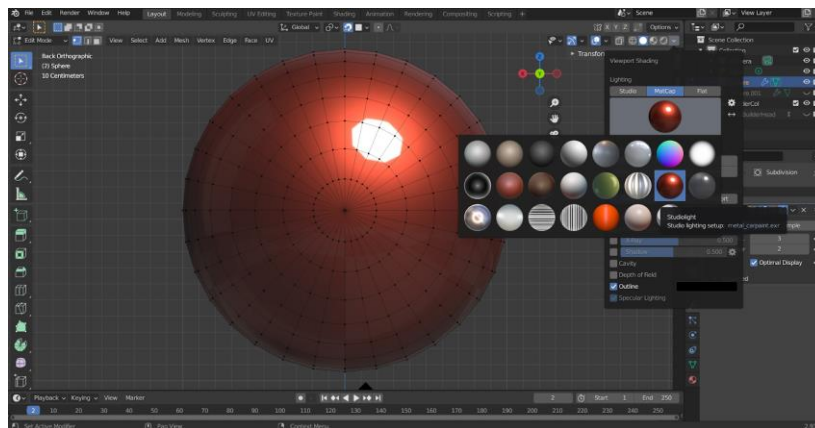
Fig. 22. Creación de malla UV Sphere y aplicación de material metal
