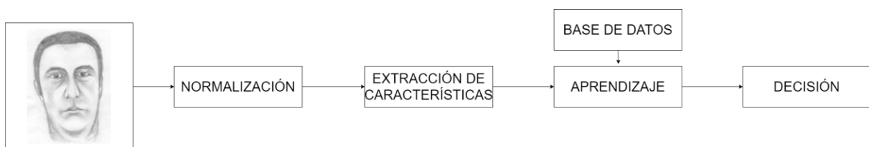
Fig. 3. Diagrama del proceso de identificación a través del modo de pruebas.
