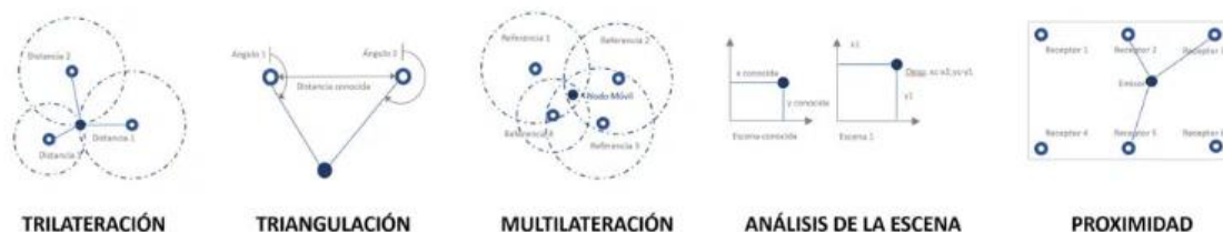
Ilustración 7-Resumen de técnicas de localización en interiores [27]
