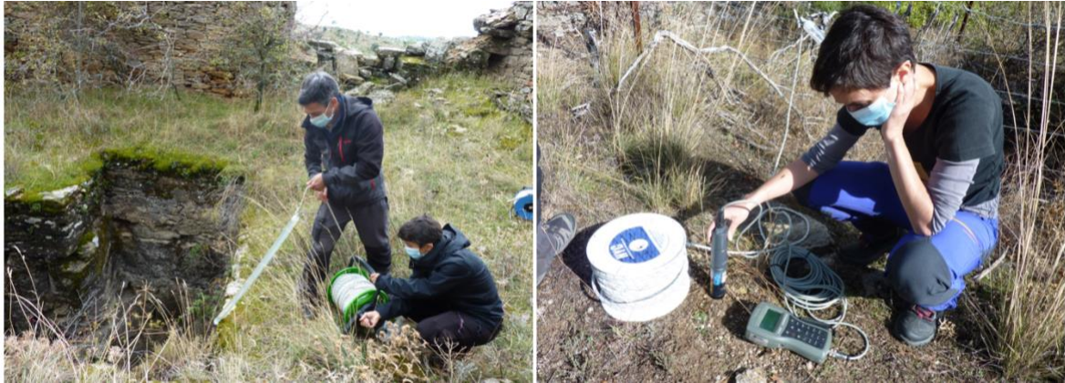
Figura 8: Toma de muestra con bailer (izquierda) y medición con sonda multiparmétrica (derecha).
