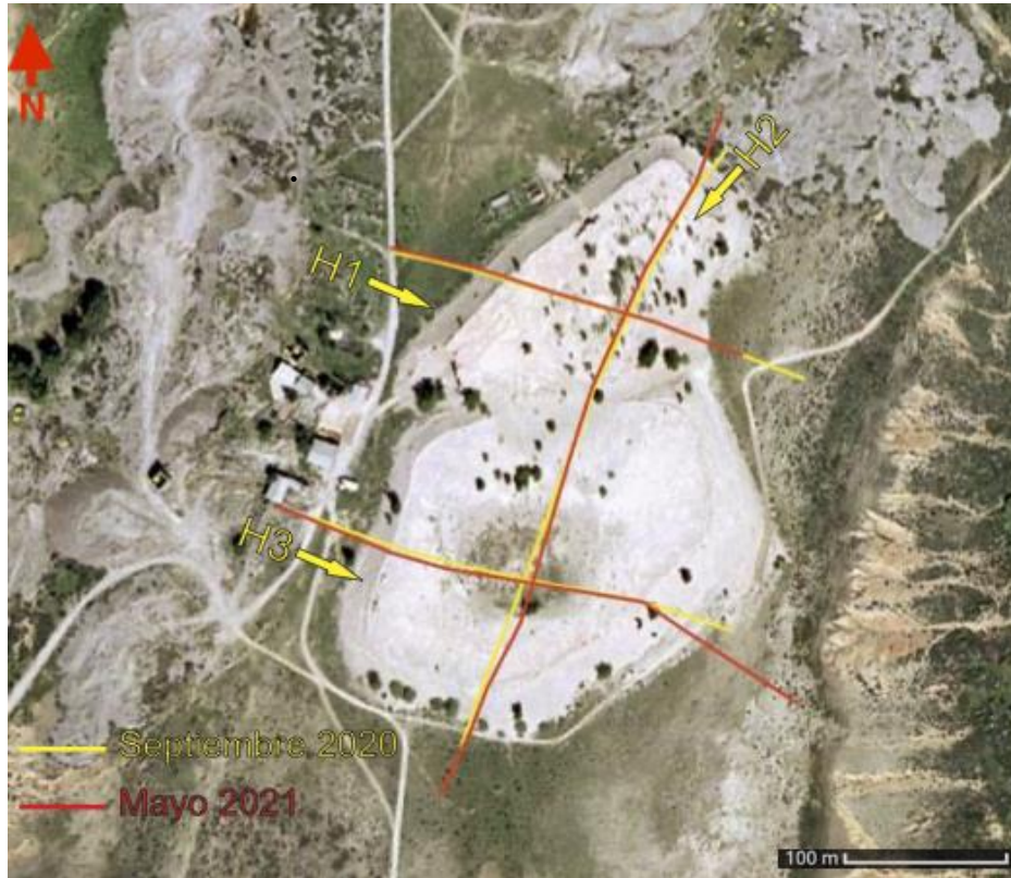
Figura 9: Situación y orientación de los perfiles de tomografía eléctrica realizados en la balsa en cada una de las campañas.
