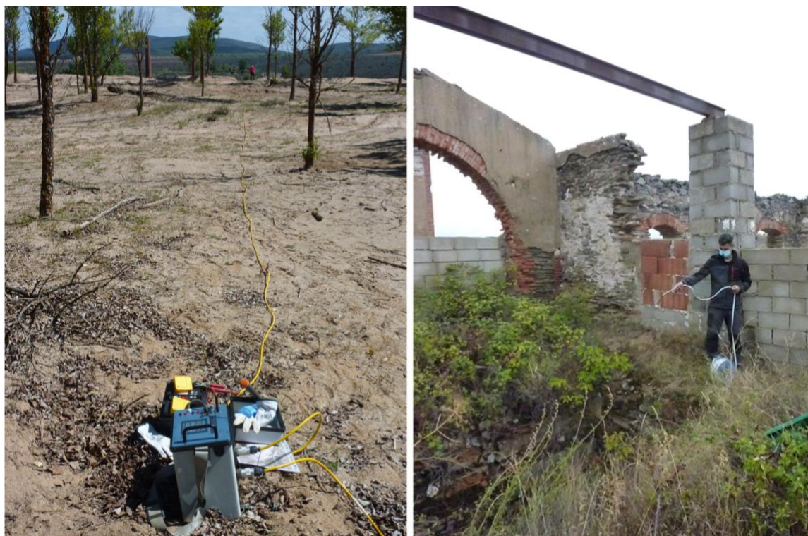
Figura 7: Adquisición de datos mediante tomografía eléctrica de la balsa (izquierda) y muestreo en el pozo de la mina Santa Teresa (derecha).
