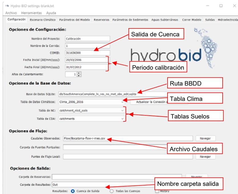
**Figura 11.** Configuración de calibración “línea base” sistema Hydro-BID, cuenca Misicuni.
