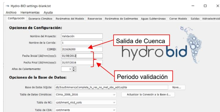
**Figura 13.** Configuración de validación “línea base” sistema Hydro-BID, cuenca Misicuni.
