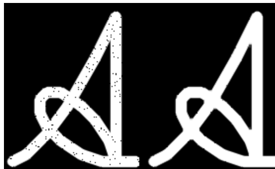
Figura 2.3: Ejemplo de la operación de apertura a partir de imagen binaria para la eliminación de pequeños agujeros [1].
