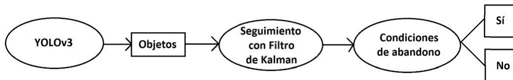
Figura 1.2: Esquema general de funcionamiento de la propuesta para detección de objetos abandonados basada en redes neuronales.
