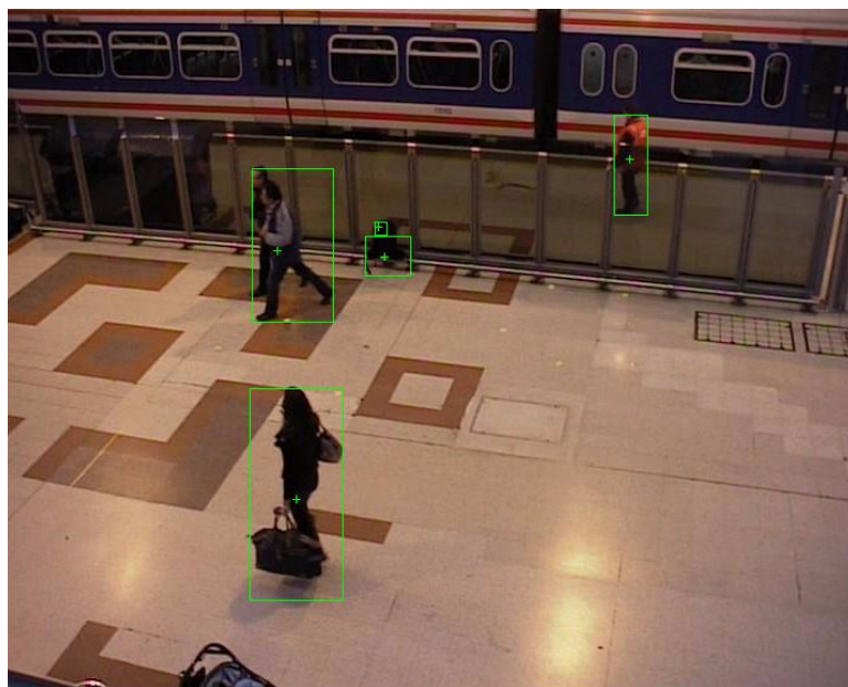
Figura 3.5: Ejemplo del análisis de formas realizado en un fotograma, con la representación mediante cuadros delimitadores.
