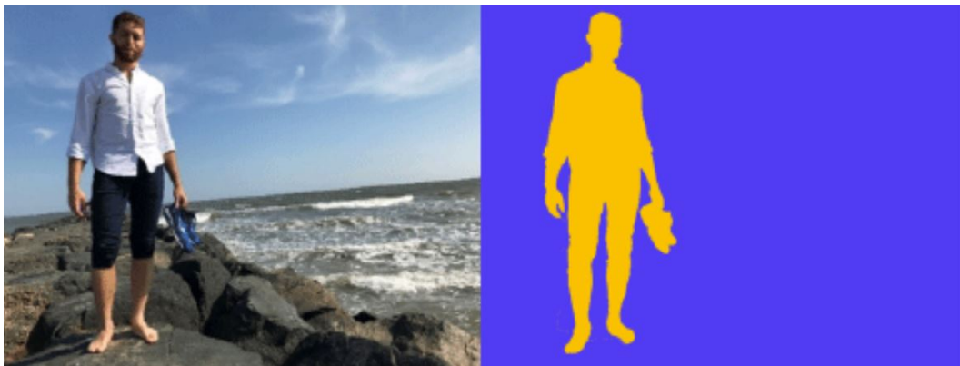
Figura 2.10: Ejemplo de segmentación de fondo de una imagen para la obtención de personas en primer plano [3].
