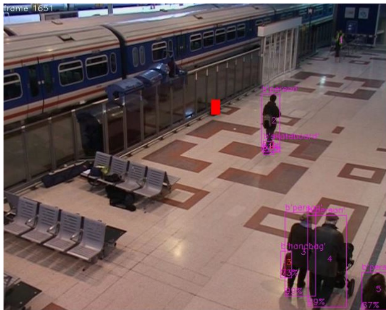
Figura 4.11: Ejemplo de detección de abandono de un objeto en la colección de PETS06.
