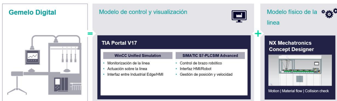
Figura 9-3Entorno de desarrollo Siemens para puesta en marcha virtual. Fuente: Siemens Industry Image Database 4.11
