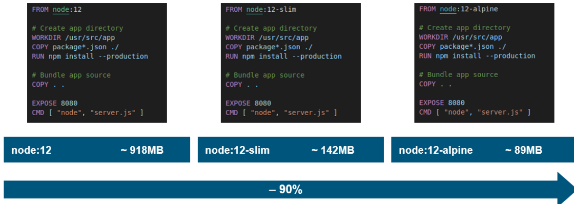
Figura 6-11 Ejemplo: reducir el tamaño total de las imágenes usando una imagen base optimizada. Fuente: Siemens Industry Image Database 4.11
