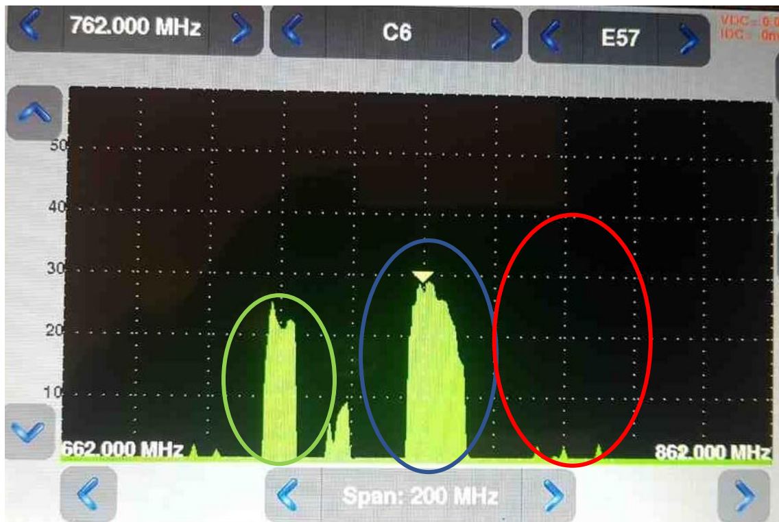
Figura 34. Medición espectro después de instalación/es.
