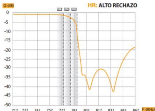
Figura 24. Ganancia del filtro según frecuencia [36].
