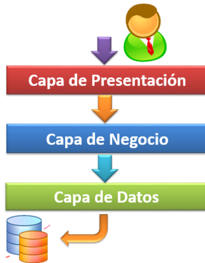
Figura 1. Esquema de una arquitectura en tres capas. Fuente: [3]
