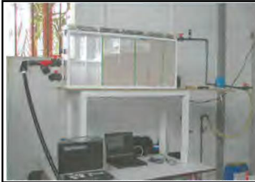
Figura 4: Planta piloto de diseño horizontal para la dosificación de carbonato cálcico (Tomado de Hernández Suárez, Suárez Pérez, Alvela, y Santana Pérez, 2004)
