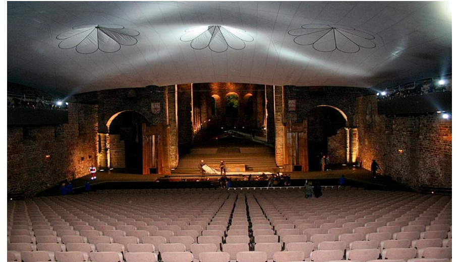
Imagen 57. Cubierta textil en las ruinas de la iglesia de Bad Hersfeld, Alemania, Frei Otto en 1968, renovada en 1992 por Stromeier Ing.( https://www.heimatverein-waltrop.de/galerie_20160801-badhersfeld.php )
