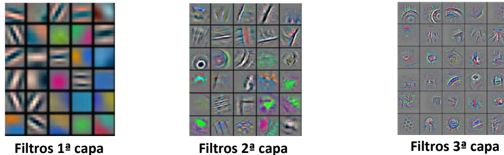
Figura 11. Ejemplo de algunos de los filtros [34] que componen las capas convolucionales de la red neuronal AlexNet [35]].
