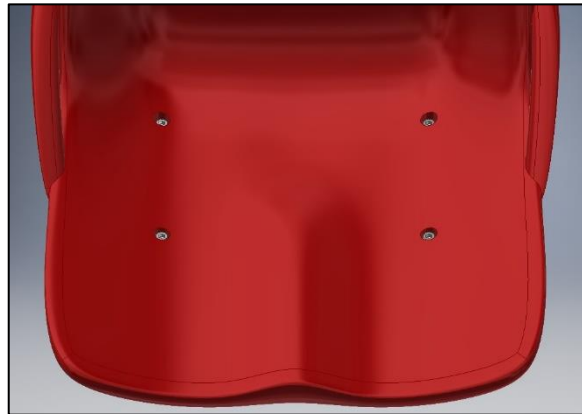
Ilustración 23: Fijación del asiento - Parte macho fijada al asiento (vista superior)
