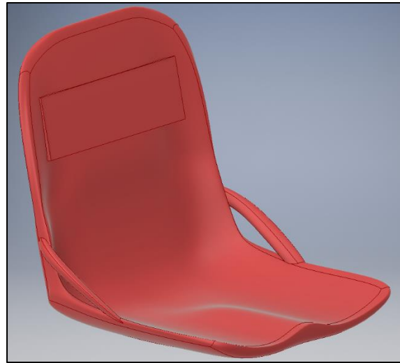
Ilustración 32: Simulación del asiento - Zona plana del respaldo
