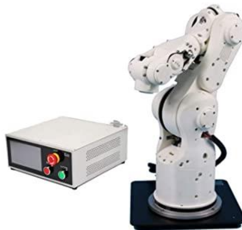
Figura 1.3: Manipulador y controlador
