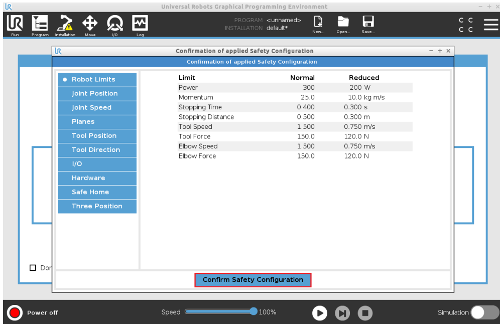
Figura 15. URSim UR5. Parámetros de seguridad
