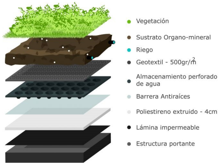
Ilustración 5: Sistema Cubierta Vegetal Fuente: Integral Grande
