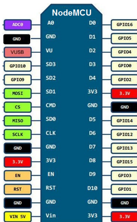
Figura 2.6: Distribución de pines del microcontrolador ESP8266MOD-12F [3].
