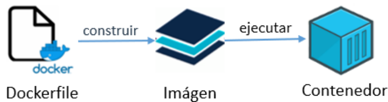
Figura 2.12: Flujo de construcción de un contenedor en docker .
