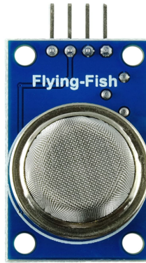
Figura 2.7: Sensor MQ135 montado sobre una placa de circuito impreso[4].
