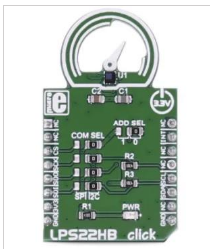
Figura 32. Módulo del sensor de presión atmosférica (LPS22HB) [17]
