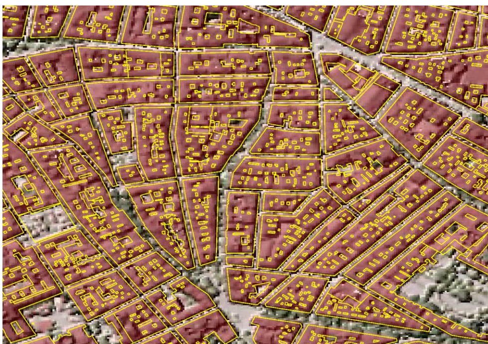
Figura 6. Edificios de la Base Topográfica Nacional (BTN25, amarillo) superpuestos al mapa-LiDAR computado por el Instituto Geográfico Nacional a partir del Modelo Digital de Elevación del Terreno, que representa las inclinaciones y orientaciones de las cubiertas.
