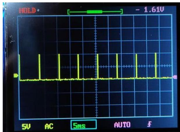
Figura 38. Tren pulsos tensión Señal pulsada principal  $V_{FP}$
