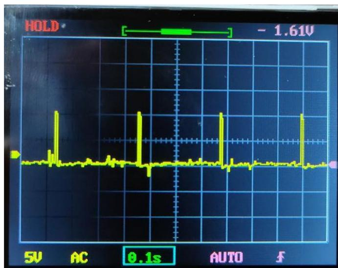
Figura 40. Tren pulsos tensión Señal pulsada principal  $V_{FP}$
