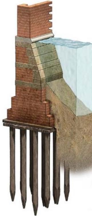
*Ilustración 41: Corte esquemático de edificio junto a un canal*
