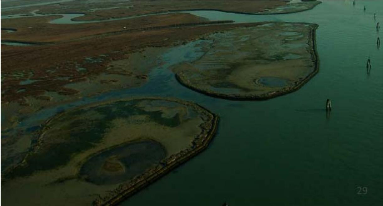
*Ilustración 54: Barreras artificiales de protección contra las olas en el borde de una zona palustre*
